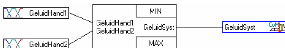
Figuur 29 Fuzzy-logicstructuur van combinatie van twee individuele handelingen met geluid. Figure 29 Fuzzy logic structure of the combination of two actions with noise.
