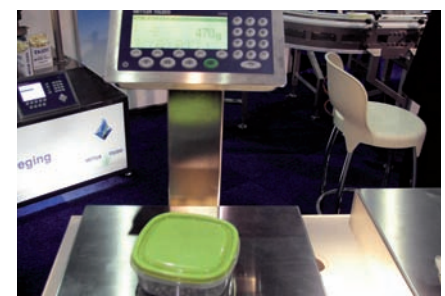
Mettler Toledo ICS 469: De kleuren geven aan of het gewicht van het product binnen de marges valt, te licht of juist te zwaar is.
