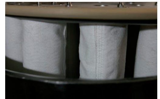
Een voorbeeld van een doekfilter dat in droge processen toegestaan is, zolang deze maar niet (in-place) nat gereinigd wordt.
