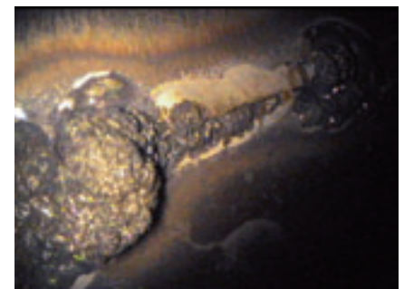
Een verbrande las, die er aan de buitenkant goed uitzag, maar die gelast is met onvoldoende of misschien wel geen backing gas.
