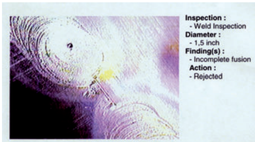
Figuur 1: Onvolledige smeltvergang.
