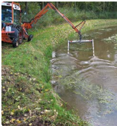
Met het A3-bodennes kan relatief visvriendelijk worden gemaaid.
