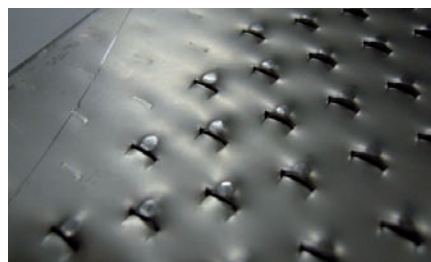
Een plaat met de zijdelings gerichte openingen. Er is een risico op kleine scheurtjes die niet reinigbaar zijn.
