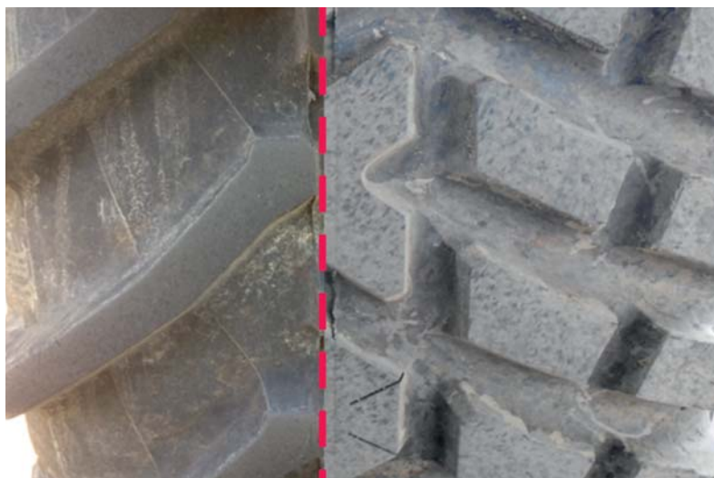
Het profiel van beide banden naast elkaar. Hier is te zien dat Nokian als het ware een extra tussenok heeft geplaatst en de nokken heeft geblokt. Dat geeft in de test een stiller rijgedrag, minder slijtage en een lager brandstofverbruik, maar is in natte omstandigheden funest.
