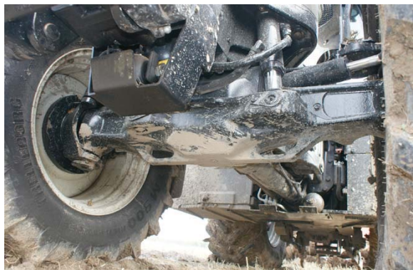
De T8 is leverbaar met alleen deze geveerde TerraGlide-voorass van eigen fabrikaat met 55 graden wieluitslag (draaicirkel circa veertien meter). Supersteer is er niet meer. De fronthead met aftakas is af fabriek leverbaar.
