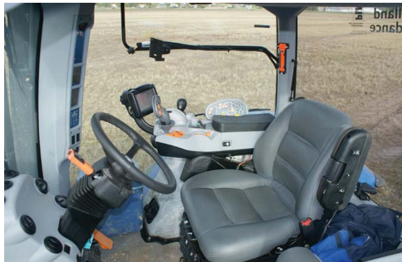
Standaard wordt de T8 geleverd met luxe interieur. De armleuningbediening is hetzelfde als in de T7-serie, evenals de bediening. Het computerscherm maakt plaats voor een groter (10,4 inch) scherm.
