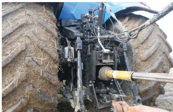
De iets langere transmissie maakt bandenmaat 900/60R42 nu af fabriek mogelijk. De achteras is verzwaard. De prestaties van hfinrichting en hydrauliek zijn hoog. Enkel de 1000-toerige aftakas is gebleven.
