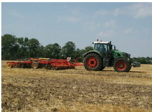
◀ De Fendt 939 Vario is het topmodel uit de reeks. Met een motorvermogen van 287 kW (390 pk) en een koppel van 1538 Nm is het een echt werk- en transportpaard.
