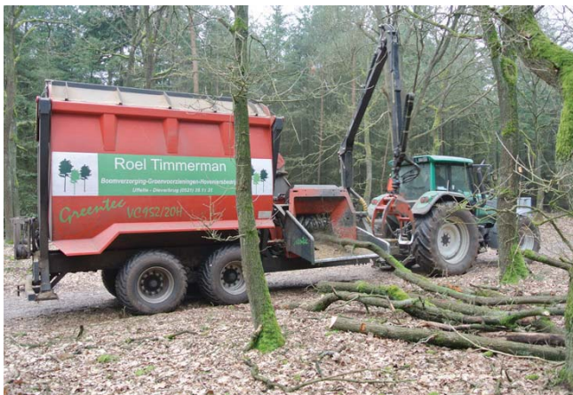
◀ De trots van de onderneming, de Ufkes Greentec 952-versnippercombinatie met laadkraan achter de Valtra-trekker.
