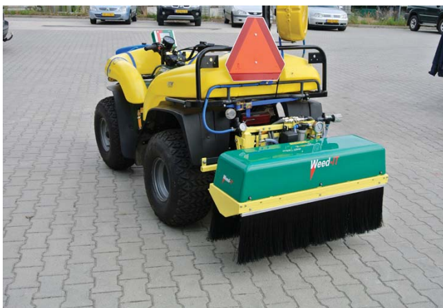
◀ De quad met aangepaste Weed-It-opbouw wordt ingezet voor onkruidbestrijding door het spuiten van azijnzuur. Erg actueel nu in 2018 glyfosaat niet meer mag worden gebruikt.
