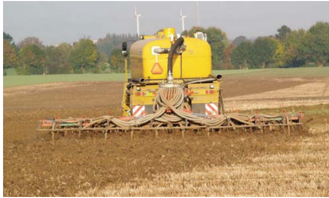
◀ De TerraGator met negen meter brede bouwlandinjecteur wordt in een straal van circa 25 kilometer vooral voor bouwlandinjectie ingezet. Het brandstofverbruik ligt bij dit werk op 23 liter per uur.
