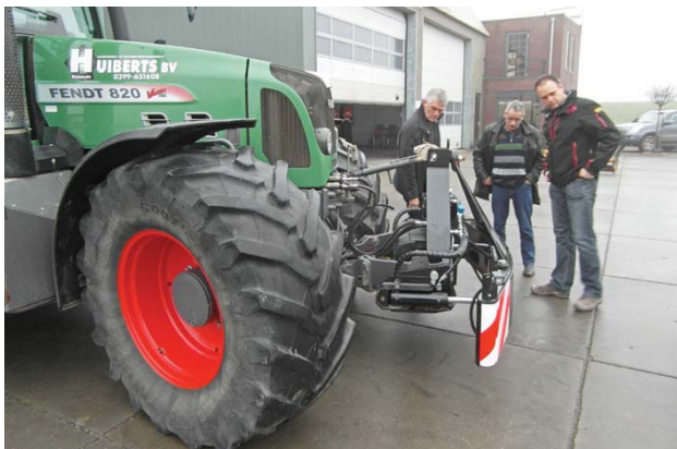
De hydraulische cilinders om de botsenergie op te vangen maken wel dat de OBТ verder naar voren steekt.
