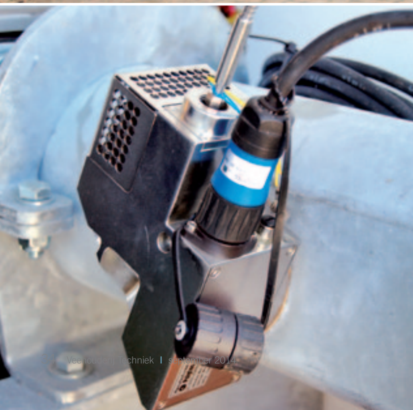
< De NIRS-sensor meet in de meststroom de mineralenwaarden.
