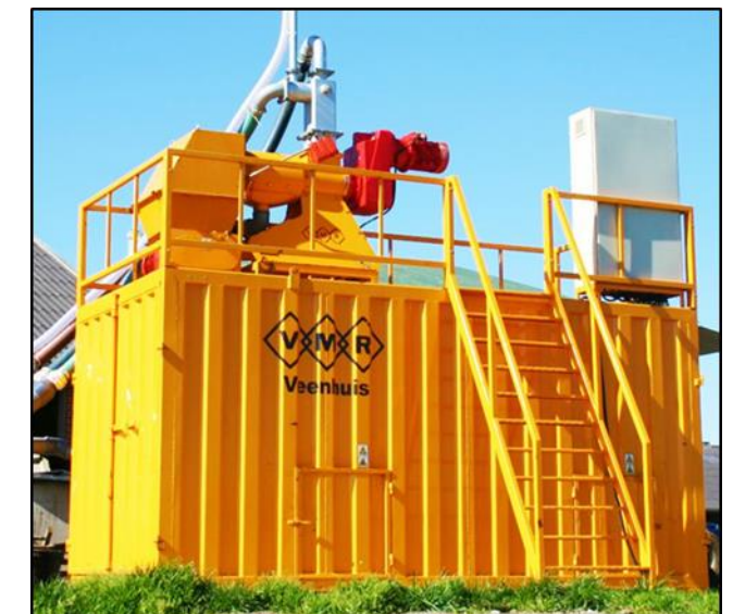
Met een hygiëniseringsunit wordt de mest exportwaardig gemaakt.
