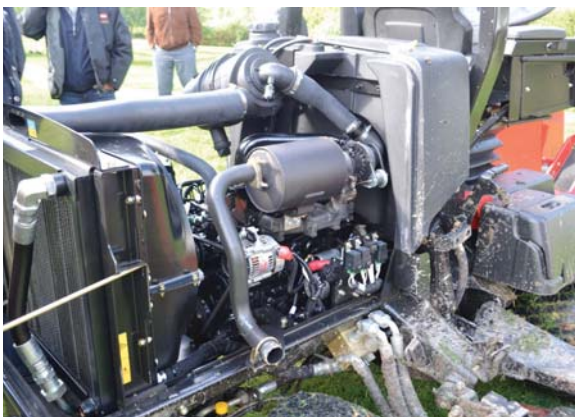
◀ De Kubota heeft plaatsgemaakt voor deze 35 kW (48 pk) Yanmar-Stage IIIa-motor. De gehele machine is voorbereid op Stage IIIb.
