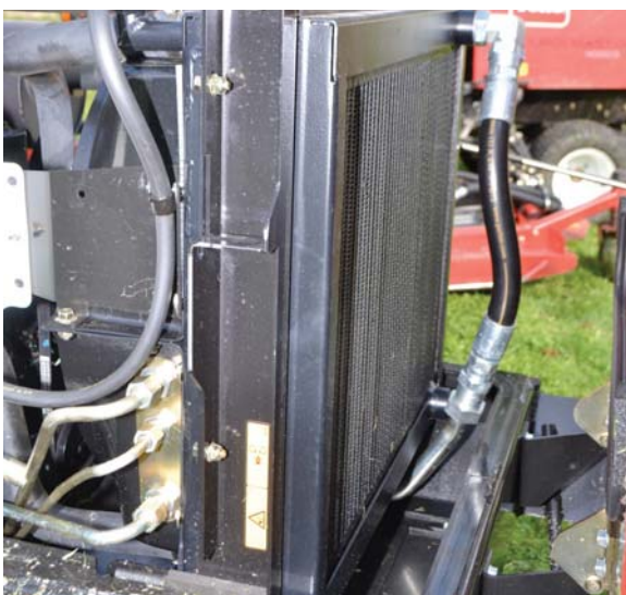
◀ Voor Stage IIIb is reeds een grote radiator geplaatst. Deze heeft een omkeerschakeling op de fan zitten om deze automatisch te reinigen als de radiator volloopt.
