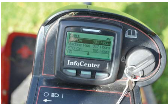
◀ De Groundsmaster 4000-D heeft een infodisplay waarop dankzij het Canbus-aansturingssysteem de settings en de maaiprestaties zichtbaar zijn.
