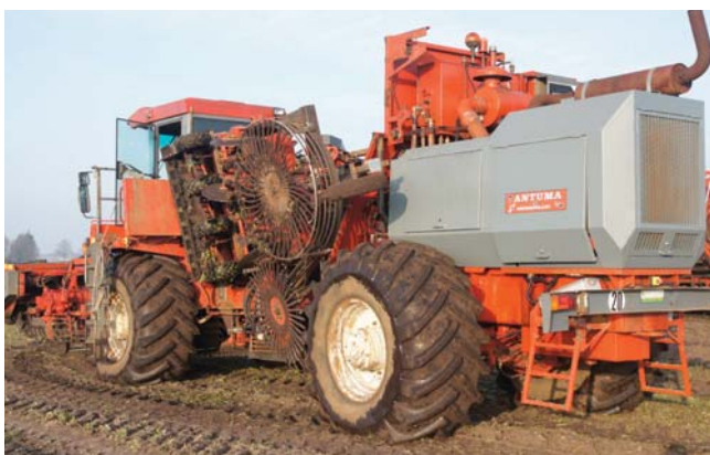
◀ In transport klappen de twee rooi-units naar binnen en blijven die binnen de drie meter transportbreedte.
