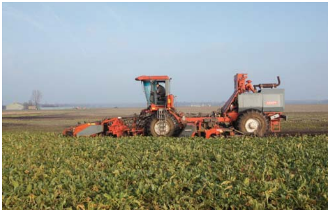
◀ Voor de bouw van de twaalfrijige voorraadrooiër heeft Antuma een Moreaurooier ontdaan van de hele bovenbouw. Alleen de motor is blijven staan. In een vervolgmiddel wil hij die ook verder wegwerken.
