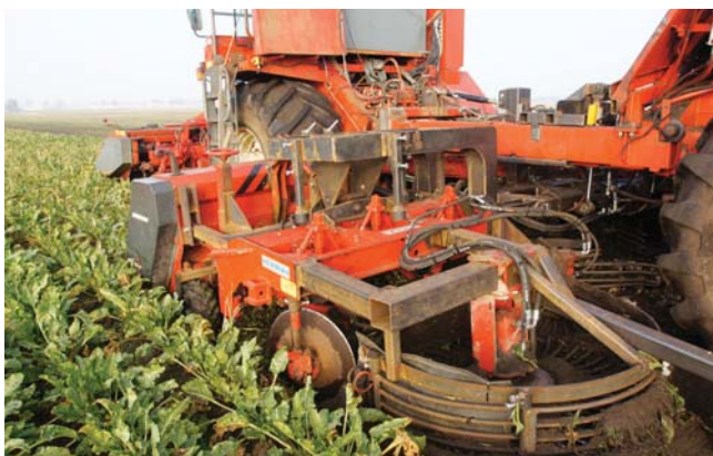
◀ De twee drierijige elementen hangen in een speciaal geconstrueerd frame. Op de huidige rooiunit zitten nog gewoon schaarlifters. Antuma vermoedt dat het geheel met roterende rooiwielen nog beter functioneert.
