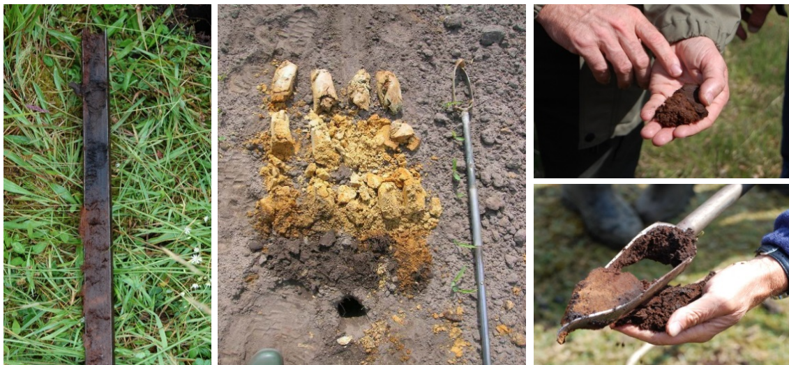
Figuur 4. Bodemprofielen uitgeboord met een gutsboor (links) en een Edelmanboor (rechts)
