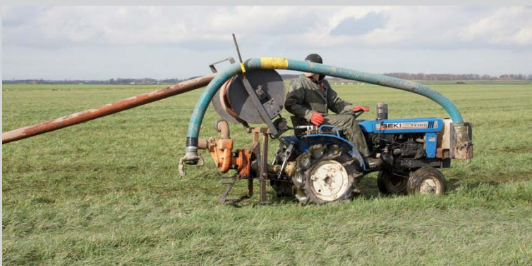
Het bedrijf houdt niet van handwerk, dus is voor het oprollen van de waterslang ook een speciale haspel op een tuinbouwtrekker gemaakt.
