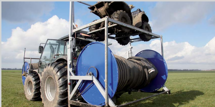
Verboom heeft voor het transport van de trike een speciaal frame gemaakt, waarmee deze voor transport boven de haspel wordt geheven.
