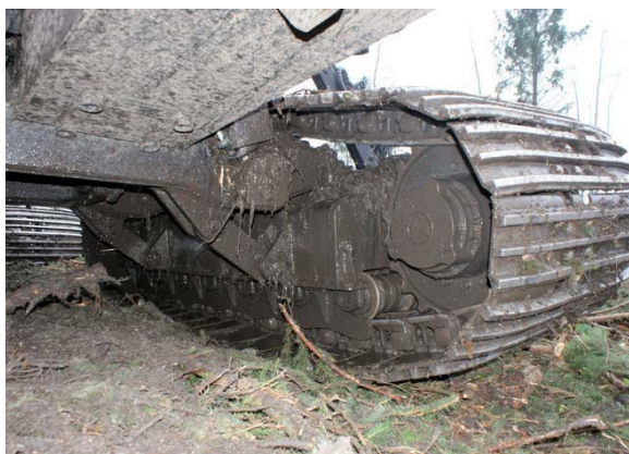
◀ De hydraulisch opgehangen, via wielmotoren aangedreven rupsen zijn zo vervaardigd dat de gebogen rupsplaten in principe in het bos niet te verliezen zijn.
