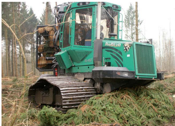
◀ Onder de kap huist een 175 kW (238 pk) Iveco N76-motor. Het onderstel heeft regelingen voor vlakstelling, individuele drukregeling per rups en een elektronische differentieel.
