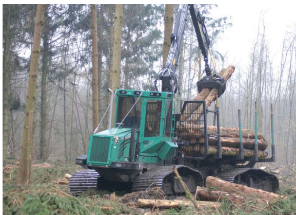
◀ De uitrijwagen heeft standaard een Waratah CF785-laadkraan. Het laadvlak is met een lengte van vier meter en een oppervlak van 4,5 vierkante meter vergelijkbaar aan dat van wielvarianten.
