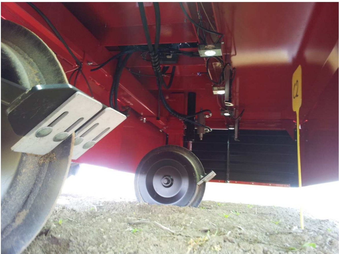
Figuur 7. Onderaanzicht van de plantentelmachine met LED belichting, camera's en hoogteregeling.
