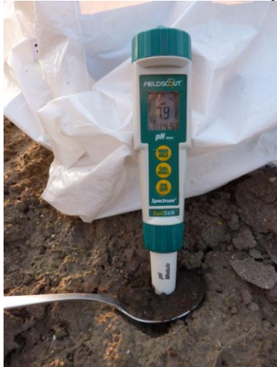
Figuur 2: De ontwikkeling van de pH-waarde van de bodem is gemeten met een Spectrum Fieldscout SoilStick pH-Meter.
