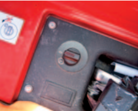
De parkeerrem is slechts een draaiknop. De aandrijving blokkeert automatisch bij stilstand.
