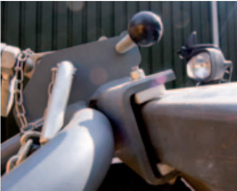
Als slijtdelen voor de sideshift monteert Aebi bij de TT 280 vervangbare kevlar-blokken.
