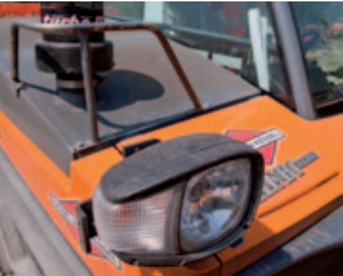
Gebroeders Van Kessel monteerte zelf een beschermbeugel voor het luchtfilter.
