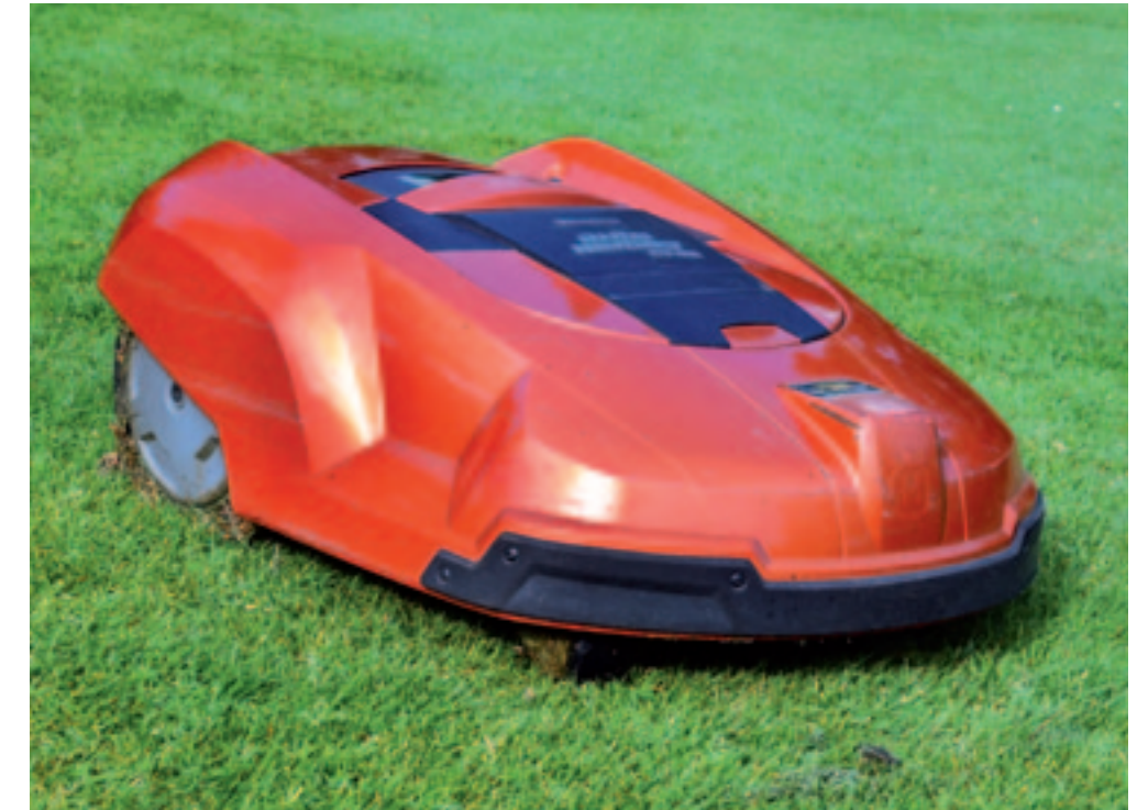
Robotmaaier hebben drie of vier wielen. De twee achterste drijven de machine aan, door een verschil in snelheid, maakt de maaier een bocht. Voorop is de machine voorzien van één of twee zwenkwielen.
