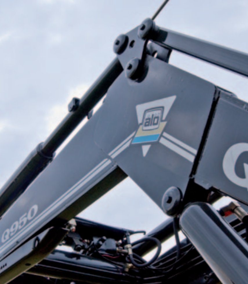
Bij deze oudere frontlader is te zien hoe mechanische parallelgeleiding werkt. De driehoekige plaat tussen stang en cilinder verstelt de bevestiging van de cilinder.
