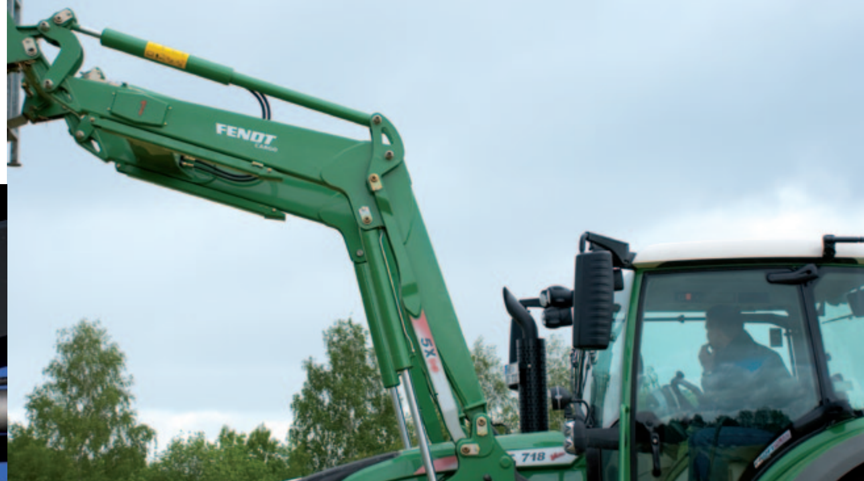
Ook Fendt past voor de Cargo-frontladers de zogenoemde Z-kinematic toe. Bij de Cargo gaat de parallelgeleiding niet via een stang in de bomen, zoals bij Stoll, maar loopt de stang langs het profiel. Daardoor beperken de bomen de stand van de driehoek tussen de stuurcilinder en de parallelstang niet.
