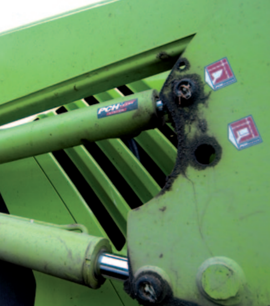
Het voordeel van de hydraulische parallelgeleiding van MX, is dat je de wijze van geleiden kunt aanpassen aan het werktuig. De bovenste cilinder is verbonden met de stuercilinder en dwingt die te verkorten of te verlengen.
