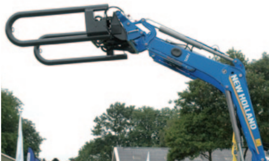
In de hoogste positie kan de stuercilinder niet uitschuiven tot de maximale lengte. Hij komt namelijk te zitten klem tussen de driehoek en de werktuigendrager. De cilinder kan de werktuigendrager immers niet de hoek om drukken.
