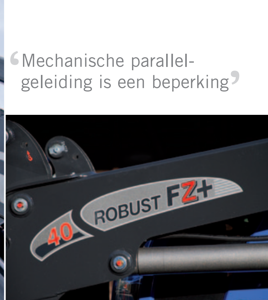
Stoll integreert bij de FZ-frontladers de stuurstang en de bomen. Zo onttrekt de stang geen zicht en kan de werktuigendrager een grotere hoek maken.
