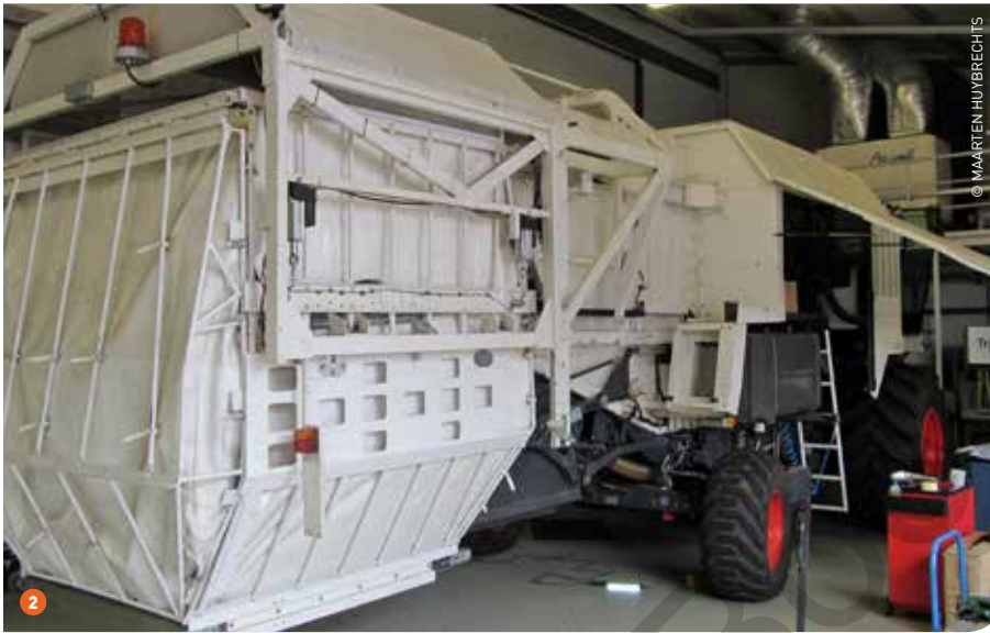
1 De levensduur van een machine wordt in zware omstandigheden getest op de hobbelbaan. De zwakste elementen van de machine begeven het hier altijd. 2 Om bij de maaidorsertest de verliezen te kunnen inschatten, wordt onder meer een totaal aangepaste refentiemaaidorser ingezet.
