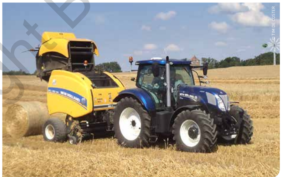
Bij de Roll-Belt ActiveSweep gaat het gewas rechtstreeks van de opraper naar de balenperskamer. Het zorgt voor een zachtere behandeling van het gewas.
