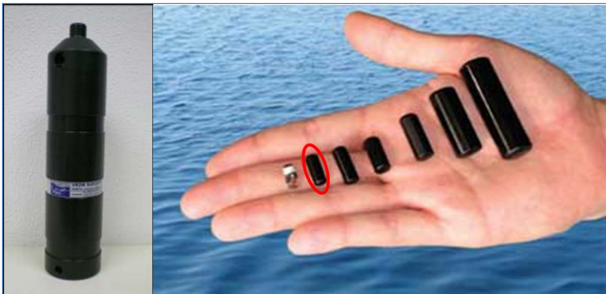
Foto: VEMCO VR2W receiver (links) en de in deze studie gebruikte zender V7 (rechts, rood omcirkeld).
