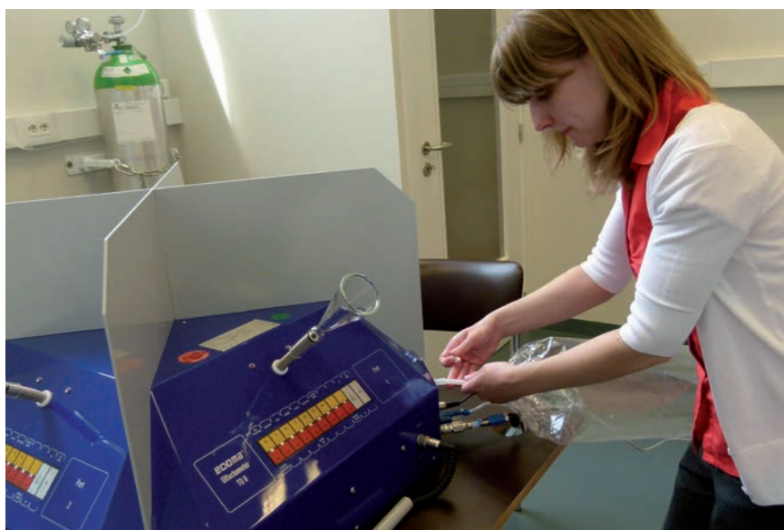
Nathalie Hove bevestigt de geurstaal aan de olfactometer.
