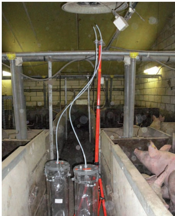
Stallucht wordt bemonsterd in lege nalofaanzakken door de kokers, waarin ze zitten, vacuüm te trekken met een pomp.
