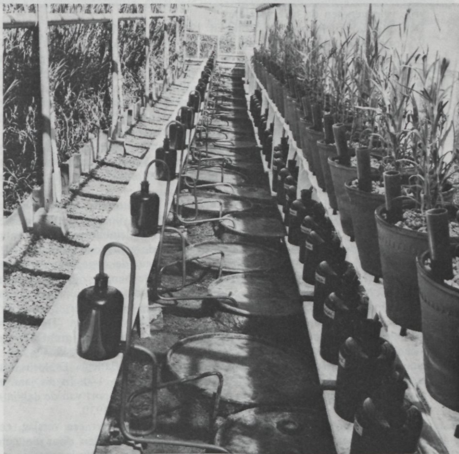
Toen de grindcultuur opkwam werd voor de anjergrindcultuur deze proefopstelling gemaakt.
