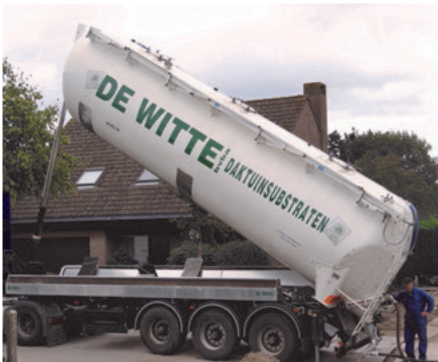
Figuur: 13.1 leveren van substraat door vrachtwagen met blaasinstallatie Bron: dewitte-bvba.be
