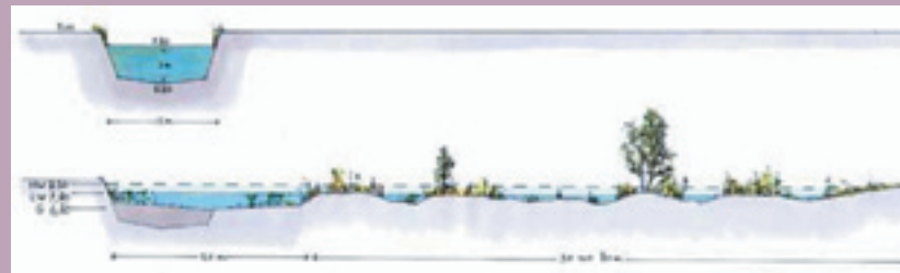
Dwarsdoorsnede huidige en nieuwe beek. De nieuwe bedding wordt veel breder dan de huidige en bestaat uit een laagwaterdeel en een hoogwaterdeel
