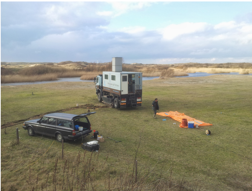
Afbeelding 4a. Impressie van de werkzaamheden: de sondeerwagen in de duinen Eerste resultaten metingen
