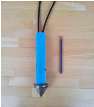
Afbeelding 3. De glasvezellus, vastgemaakt aan de stalen kegelpunt De buis wordt weer opgehaald, de kegel met glasvezellus blijft in de bodem achter.
