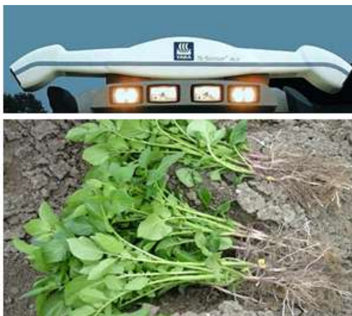
Figuur 3. Uitvoering reflectiemetingen met de Yara N-Sensor en drogestofanalyses van bovengrondse gewasdelen
