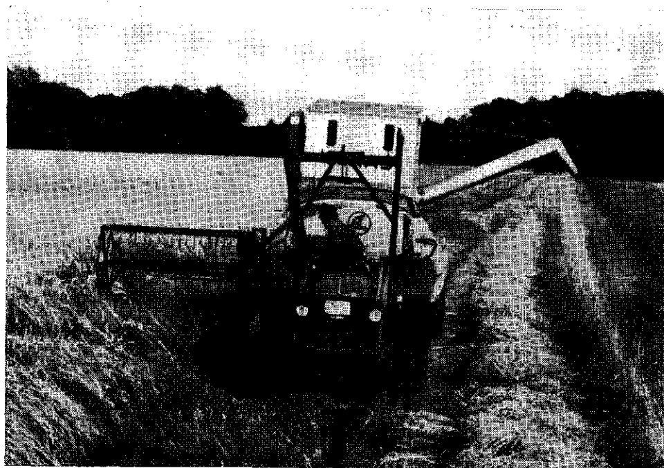
Getrokken maaidorser „Claas” met graantank (foto Fa. Hunse, 's-Gravenhage)
