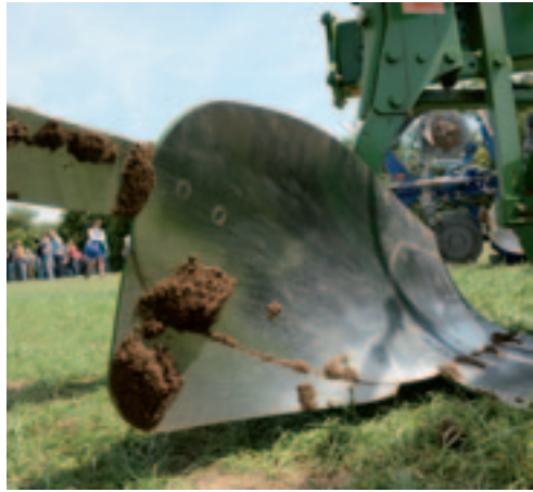
^ Met 710 band door de voer Amazone kan onder het laatste raster van de de Cayron 200-ploeg een voorverbreder schroeven. Die duwt grond weg zodat je met 70 cm brede 710 banden door de voor kunt rijden. Dat kost ongeveer 2 procent extra brandstof. Het ploegbeeld veranderde niet.
