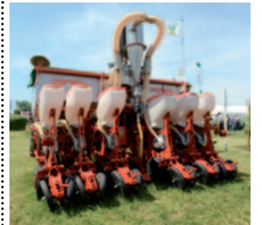
^ Bijvriendelijke zaaimachine Om te voorkomen dat stof van maiszaadcoating in het milieu komt en bijensterfte veroorzaakt, bedacht Bayer een cycloon die de lucht na de elementen opvangt en zuivert. Het stof gaat via een enkel zaaielement het zaai bed in.
