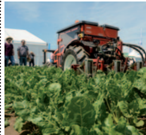
^ Robottrekker De universiteit van Hohenheim bouwde een 20 kW Hakotractor om tot robot. Aan de hand van tijdens het zaaien verzamelde gps-gegevens doet hij zijn werk volautomatisch. Gps valt soms weg en daarom navigeert de volgende versie met camera's over het perceel.
