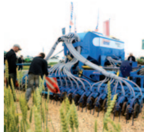
^ Modulaire zaaimachine Farnet bouwt de getrokken Falcon-zaaimachine modulair op. Onder de tank kun je verschillende eggen en egaliseringsbalken monteren. Erachter diverse zaaimachines. Er is ook een tank met drie compartimenten, zodat je twee soorten zaai en kunstmest kunt zaaien.
