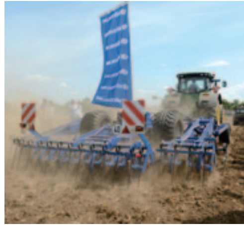
^ Diepte via isobus De werkdiepte van de Köckerling Vector is via Isobus te regelen. Ga je ervan uit dat bij een hoge graanopbrengst veel stro ondergewerkt moet worden, dan is de taakkaart uit een opbrengstkaart af te leiden. Je kunt ondiep werken op plaatsen met veel stenen.
