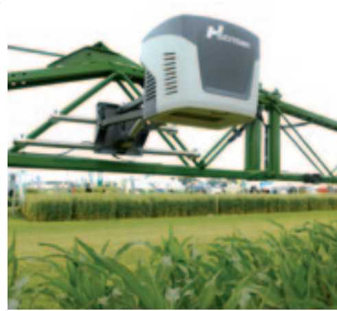
^ Plaatsgewijs spuiten Agricoms H-sensor onderscheidt met een camera onkruidhaarden van cultuurplanten. Door op elke sectie van de spuitmachine een sensor te monteren is plaatsgewijze bestrijding mogelijk. Een set van vier sensoren en Isobus-monitor kost 40.000 euro.
