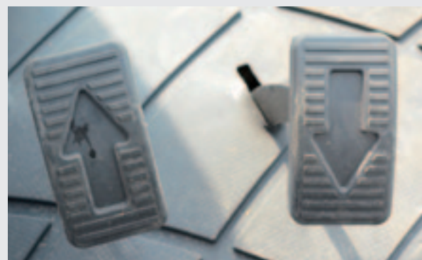
Voor versnellen, vertragen en van rijrichting wisselen, heeft de Koreaan twee pedalen. Net als andere hydrostatische trekkers.
