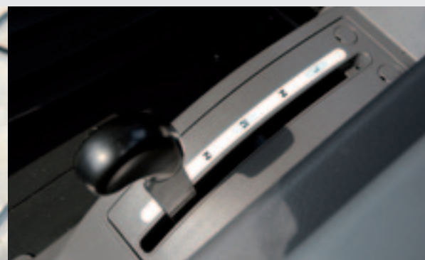
De hydrostatische transmissie kent drie snelheden, die met een hendel links naast de bestuurdersstoel te schakelen zijn.
