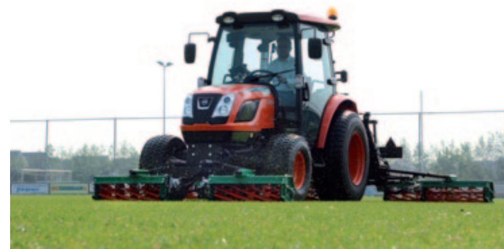
Door een maaicombinatie aan de hydrostatische Kioti NX6010 te monteren, ontstaat het werkgemak van een zelfrijder. Door zijn lage gewicht en grote banden, is de bodemdruk laag. En je kunt ermee over de weg van klus naar klus rijden.
