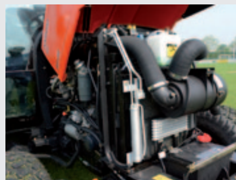
De trekker wordt aangedreven door een driecilinder dieselmotor van Kioti. Hij levert een vermogen van 44 kW (60 pk).
