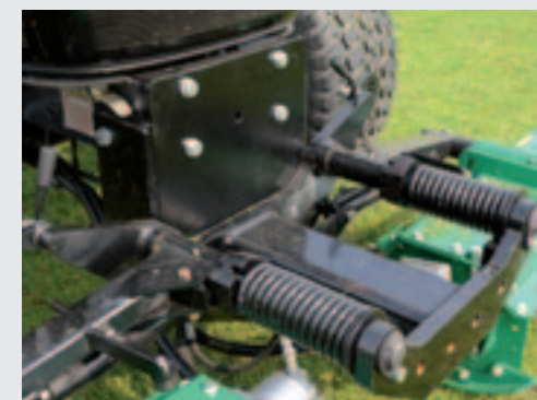
De twee frontmaaiers van Ransomes zijn opgehangen in een door Pols zelf gefabriceerd frame.
