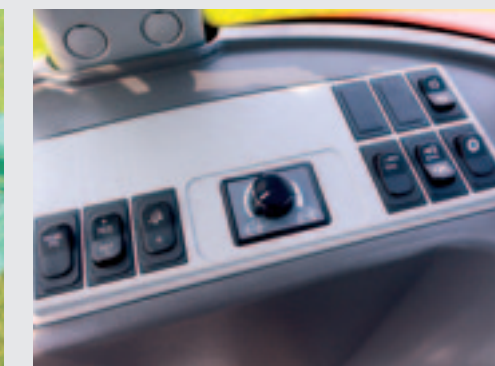
Het bedieningspaneel aan de rechterkant van de bestuurdersstoel. Hier stel je alle hydrostatische functies van de trekker in.
