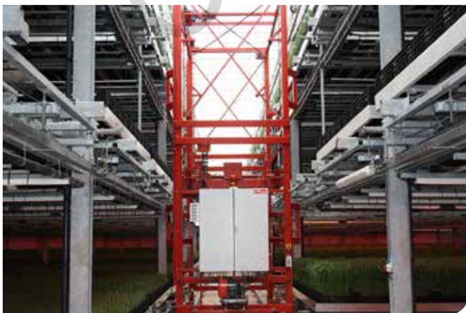
▲ Een robot zorgt voor alle containerverplaatsingen in het meerlagensysteem
