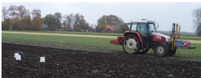
Figuur 1. Uitvoering van de broeikasmetingen met links de emmers waarin het gas wordt opgevangen en voorop de trekker de meetapparatuur.
