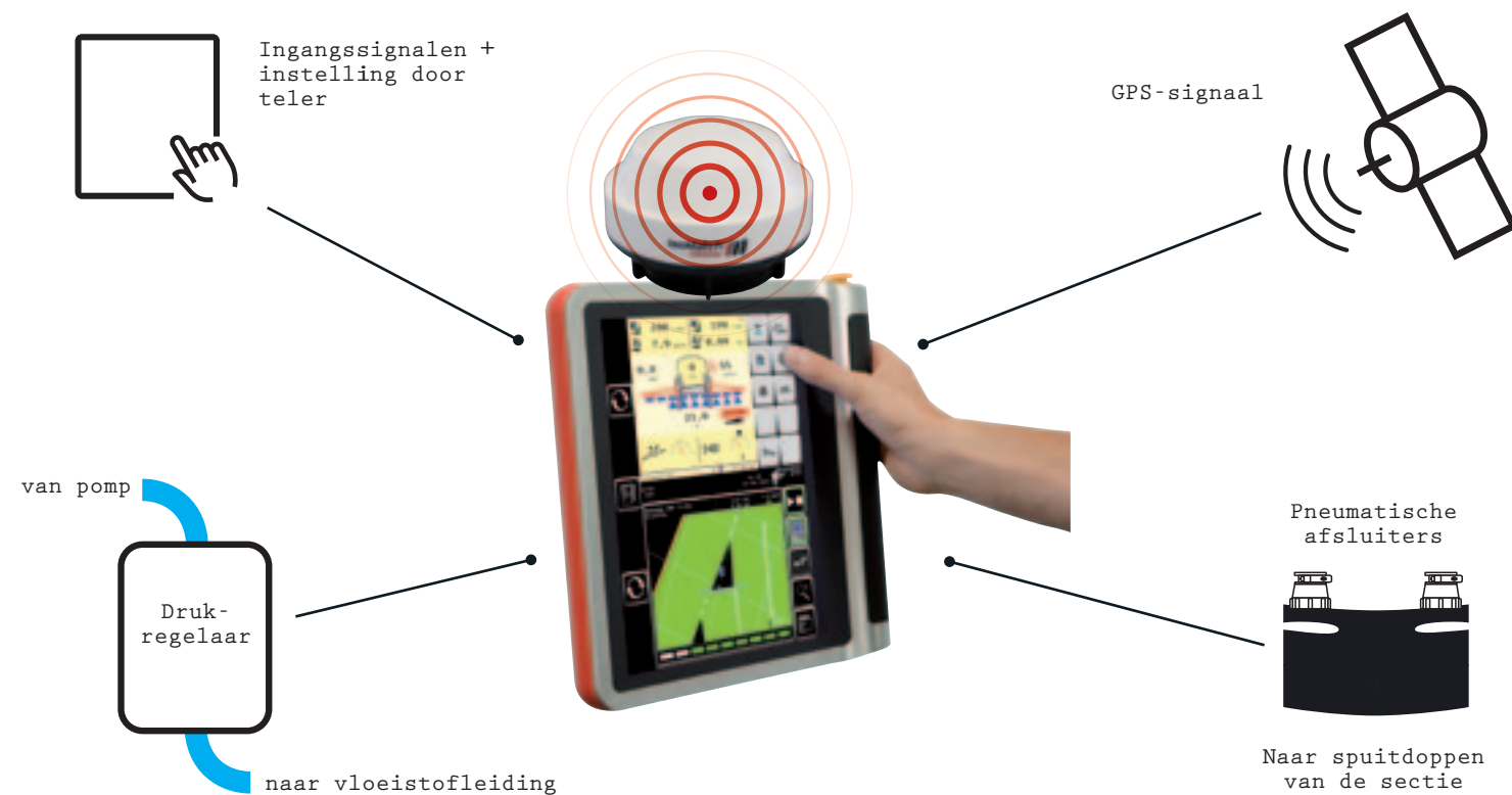
^ Schema van de sectie-afsluiting door pneumatiek.
