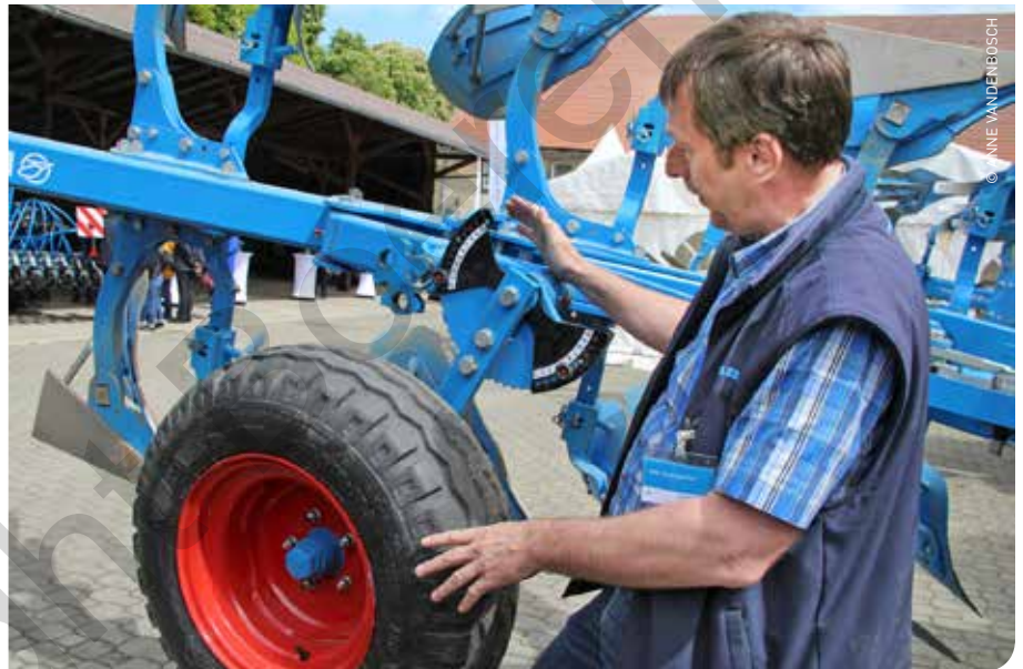
Met Turncontrol Pro bij Juwel 8 worden de ploegwenteling en de instelling van de overrug-overbuikpositie, de werkbreedte en werkdiepte standaard via het hydraulische steunwiel geregeld.
