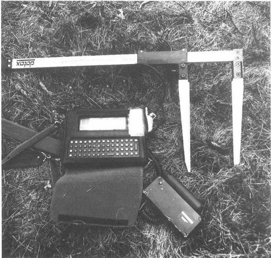
"een veldcomputer met daaraan gekoppeld een elektronische boomklem en elektronische hoogtemeter"
