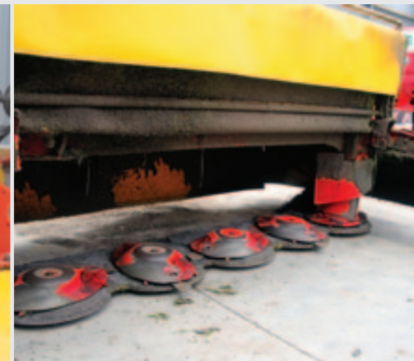
De schijven van de Novacat bewegen tegen elkaar in. De messen verwissel je door een bout los te draaien.
