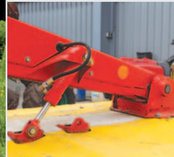
De positie van de bodemdrukcilinder voor het maaien met een 3,50 m brede frontmaaier. Is die maaier smaller, dan gebruik je het andere punt.
