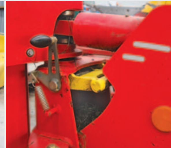
Een vergrendeling zorgt ervoor dat er geen kracht op de zwenkcilinder staat als de machine is afgekoppeld.
