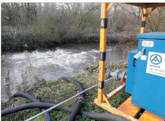
Op de terreinen van de rioolwaterzuivering Eindhoven in Tonghe is nu nieuwe zuurstof in het water. Foto: Ton van de Meulenbelt
