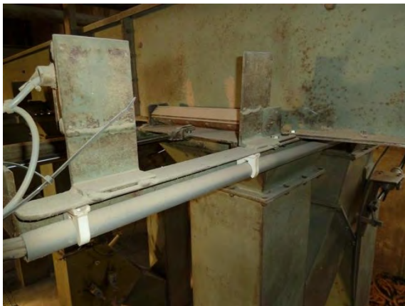
Afbeelding 20 Een ketting kan verschillende lospunten hebben. Deze worden afgesloten met schuiven. De schuiven zijn op dezelfde hoogte gesitueerd als de bodem van de ketting omdat er anders product in de ruimte tussen de ketting en de schuif achterblijft.
