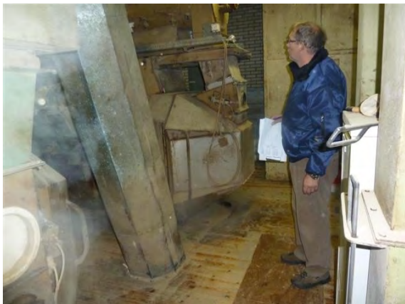
Afbeelding 17 Transport onder een hellingshoek met hulp van een steile vijzel van de ene pers naar de andere.
