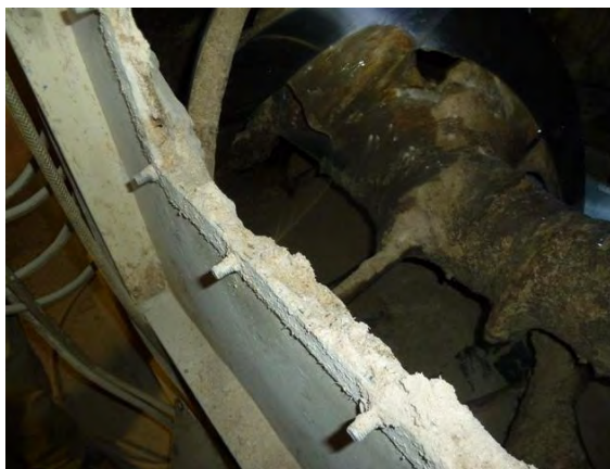
Afbeelding 11 As van lintmenger met aancoeksel.
