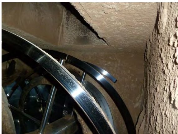
Afbeelding 10 Een lintmenger waar aan de wand en bovenkant stof blijft hangen.
