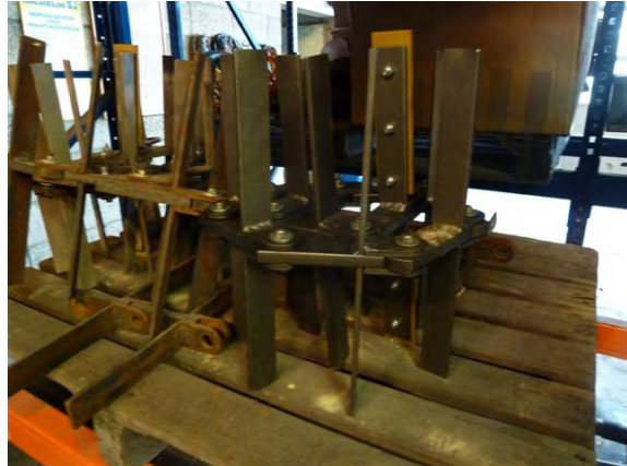
Afbeelding 19 Ketting met enkele schalmen (de afgebeelde ketting is niet in gebruik en staat op zijn kant).
