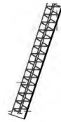
Afbeelding 17 Transport onder een hellingshoek met hulp van een steile vijzel van de ene pers naar de andere.
