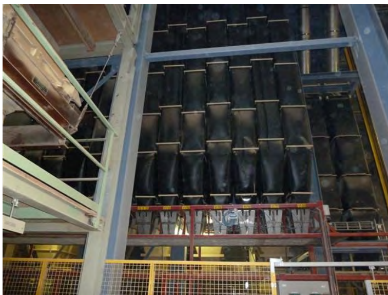
Afbeelding 3 Opslag in silo's van voormengsels en andere voedermiddelen die bijgestort worden.
