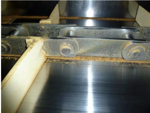
Afbeelding 18 Ketting met kunststof meenemers waarbij duidelijk is te zien dat er tussen de schalmen in het midden van de ketting product achterblijft.
