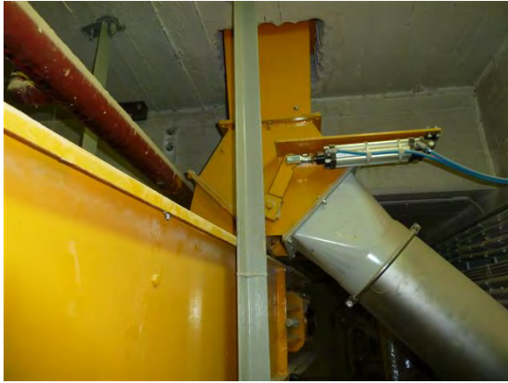
Afbeelding 26 en Afbeelding 27 Voorbeelden van klepkasten direct onder de afvoer van de pers.
