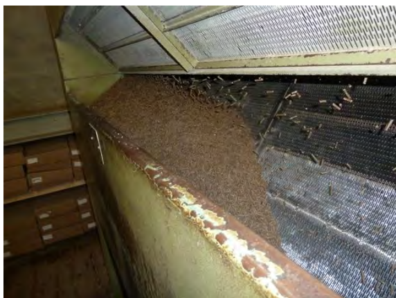
Afbeelding 30 Cascadekoeler die gevuld wordt met korrels.
