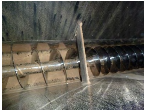
Afbeelding 8 Onderbunker met transportschroef en restanten product.
