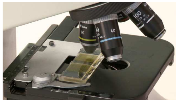
Een telkamer voor het tellen van eitjes van maagdarmwormen onder de microscoop (EPG's)
