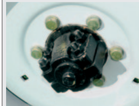
Een flens is met vier bouten op de steekas geklemd.
