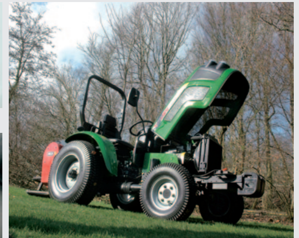
Voor het dagelijks onderhoud kan de motorkap van de Chery royaal omhoog. Onder de motorkap heeft Chery een driebcilinder watergekoelde, direct ingespoten dieselmotor gemonteerd.
