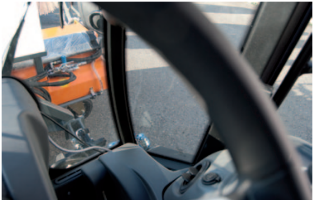
De cabine heeft er voorin twee stijlen bijgekregen. Daardoor ontstaan schuine hoeken naast de voorruit die moeten zorgen voor uitmuntend zicht op het werktuig.
