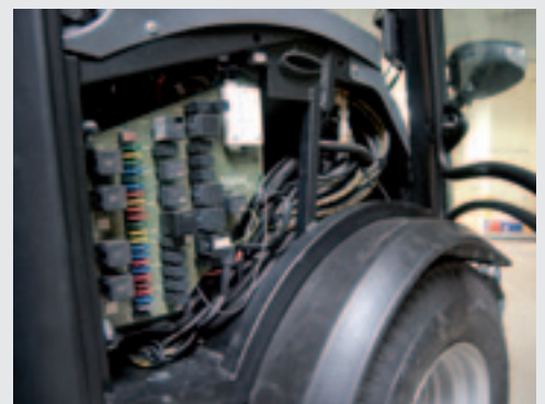
De Kärcher is deels elektronisch aangestuurd. De zekeringen zijn goed bereikbaar.
