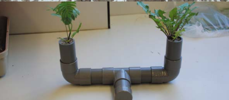
Boven: Engerting; Onder: Olfactometer voor het testen van de reactie van insecten op geurprikkelers.
