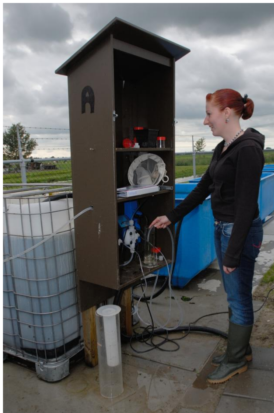
Foto 3.6. De kast met de voedingspompen. De aanzuigslangen waren ca. 30 cm kort.
