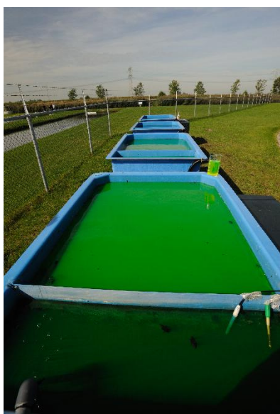
Afbeelding 4.3. Kleuring door Uranine na volledige menging door alle mesocosms.
