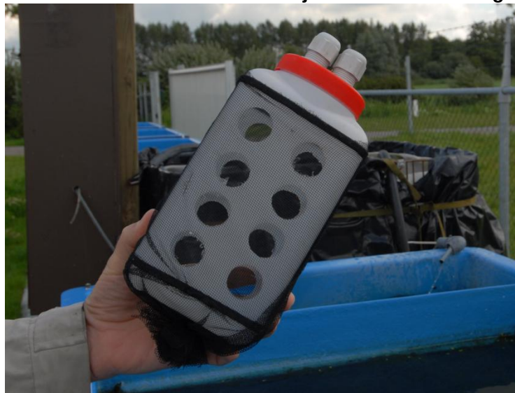
Afbeelding 1: Verbeterde versie van het netje rondom de aanzuigslangen
