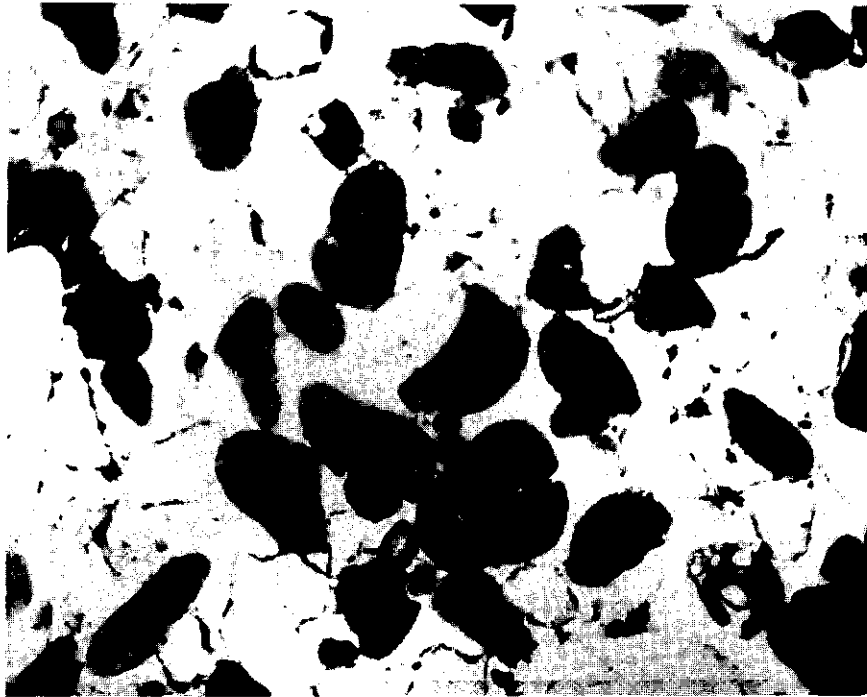
Fig. 14 Verwerende glauconiet, soms met meerdere barstjes in één korrel en met of zonder de zwarte korreltjes (slijpplaat C). Glauconiet verweert in deze zanden vooral aan de randen en in breukjes. Hierbij wordt vaak amorf ijzerhydroxide afgezet. Vergroting 64 x.
